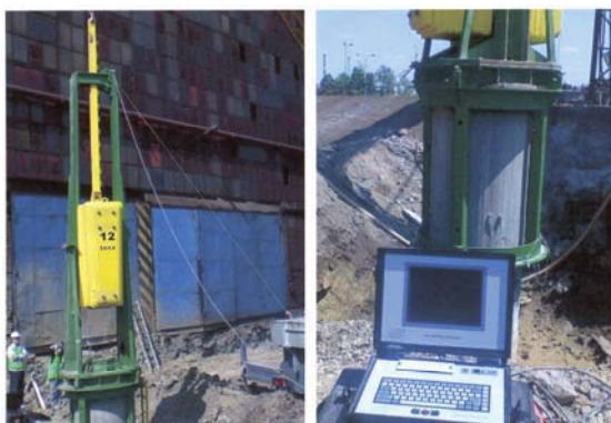
Slika 6. Oprema za dinamičko ispitivanje pilota
