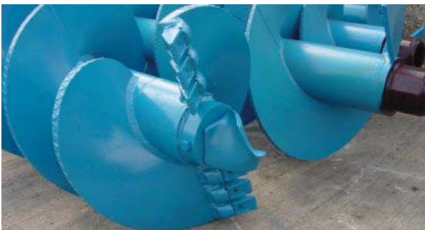
Slika 3. Svrkla za izvedbu CFA pilota
