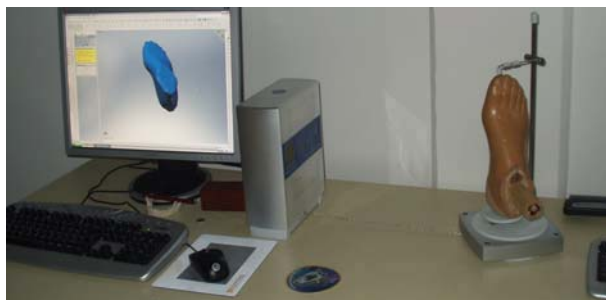
Slika 10. Skeniranje modela noge Skenerom NextEngine
