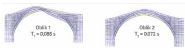
Slika 19. Prva dva oblika slobodnih oscilacija mosta
