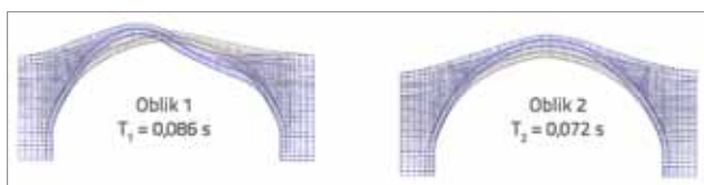
Slika 19. Prva dva oblika slobodnih oscilacija mosta
