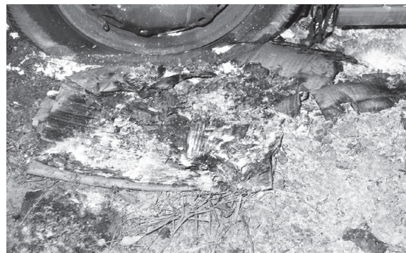
Slika 8 (lijevo): Paležom posve opožaren cijeli prednji dio osobnog automobila, uključujući sve (sa)gorive sadržaje unutar prostora pod poklopcem motora (Medić, 2010)
