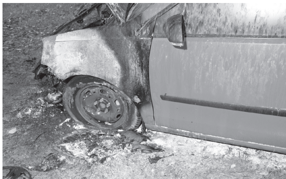
Slika 8 (lijevo): Paležom posve opožaren cijeli prednji dio osobnog automobila, uključujući sve (sa)gorive sadržaje unutar prostora pod poklopcem motora (Medić, 2010)
