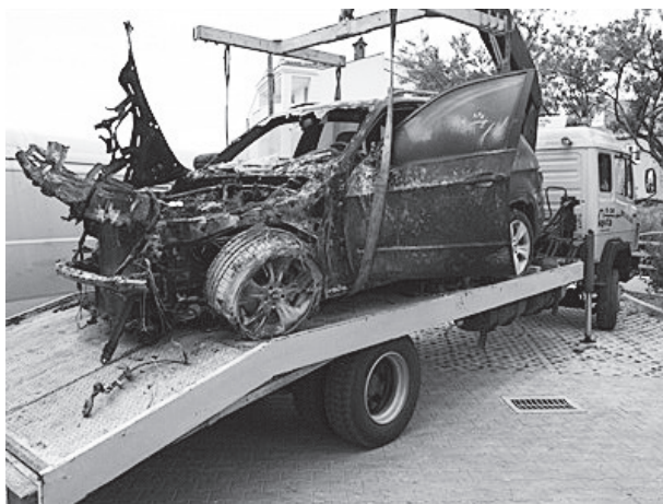
Slika 12: Posljedice posvemašnjeg uništenja luksuznog osobnog automobila u požaru (slučaj istražno utvrđenog podmetanja požara pod vozilo) 30
