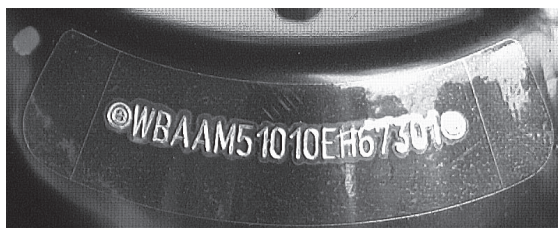
Slika 6: Broj šasije očito je svjetlije boje
