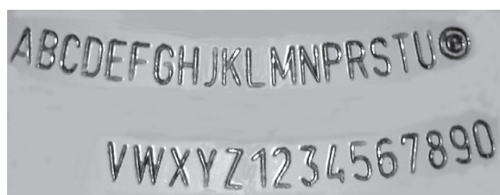
Slika 6.1: Brojevi šasije – specijalna veličina (font) slova
