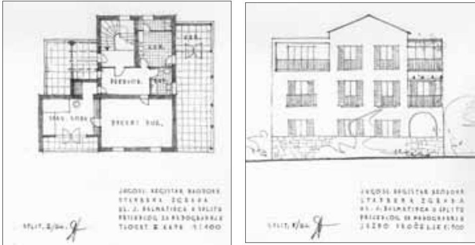
Slika 36. i 37. Tlocrt i pročelje stambene zgrade Jugoslavenkog registra brodova u Ulici Jurja Dalmatinca u Splitu. Druževićev prijedlog za nadogradnju drugog kata iz 1964.
