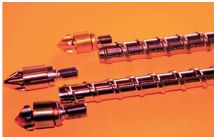
SLIKA 5 – Pužni vijci povišene površinske tvrdoće
