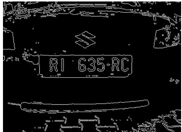
Slika 4. Detekcija rubova primjenom Canny i Sobel gradijentnog filtra na slici prije (a) i poslije (b) binarizacije Figure 4 Edges Detection by Using Canny and Sobel Gradient Filter before (a) and after (b) Binarization
