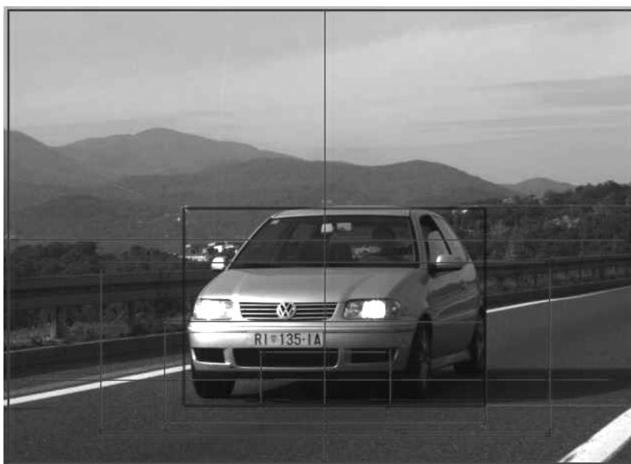
Slika 2. Otkrivanje vozila u jednom od okvira videosnimke Figure 2 Process of Detecting a Vehicle in a Dynamic Scene
