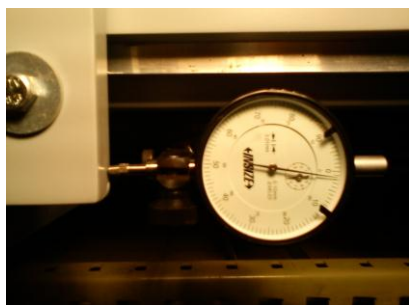
Slika 11. Prikaz testiranja pomoću mjernog sata - završna pozicija
