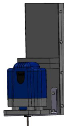
Slika 8. Platforma s koračnim motorom – gibanje po Y osi
