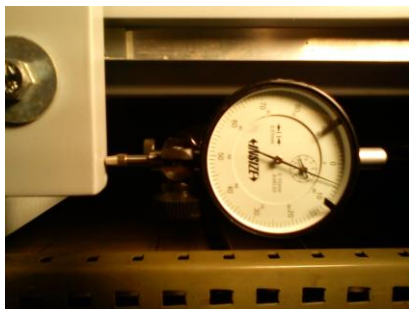
Slika 10. Prikaz testiranja pomoću mjernog sata - početna pozicija
