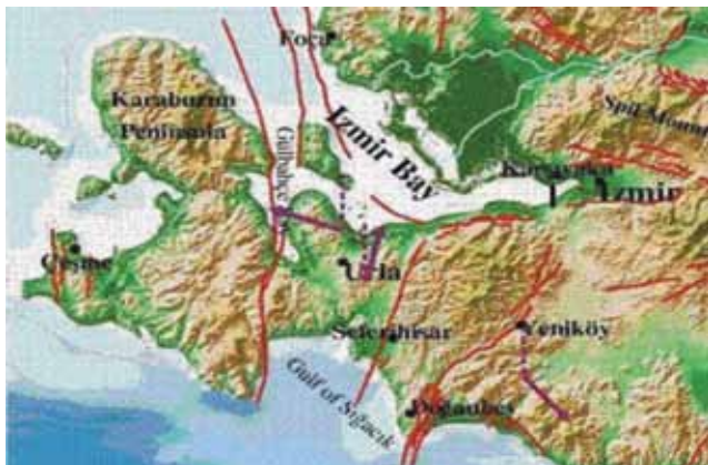
Slika 8. Prisutnost poznatih rasjeda blizu predložene trase tunela
