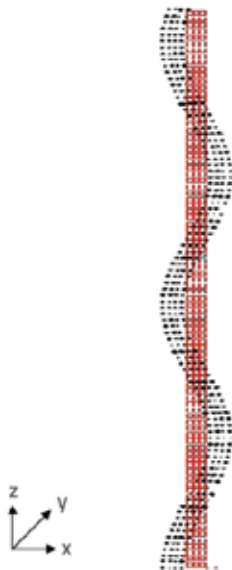
Slika 10. Deformacija tunela uzrokovana u spojenim prefabriciranim betonskim elementima uslijed djelovanjem potresa magnitude M = 7
