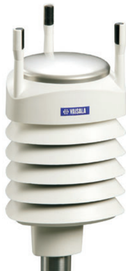
Slika 1. Senzor Väisälä WXT510 za mjerenje atmosferskih parametara (URL 1).
