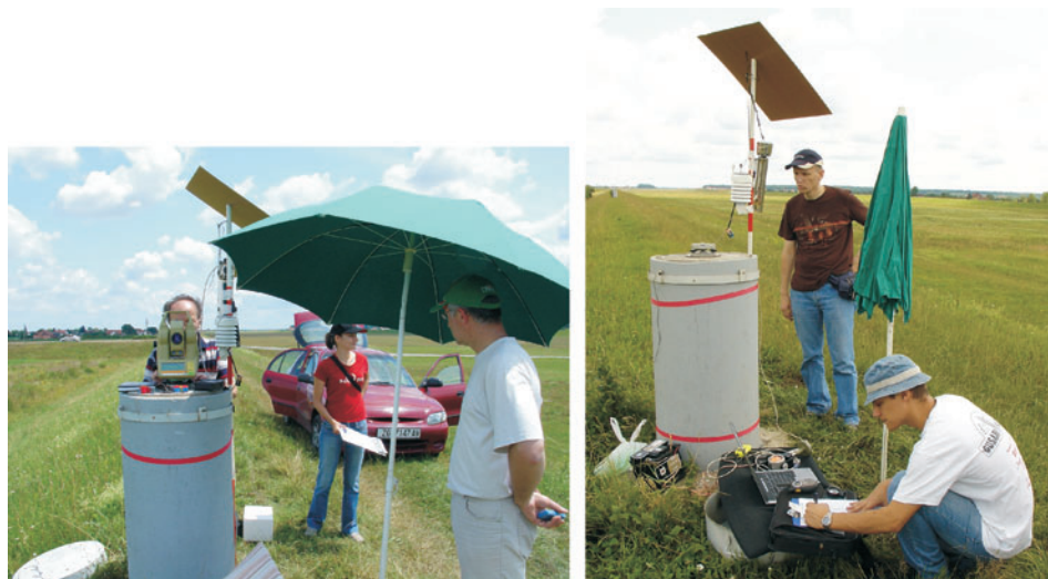
Slika 11. Zaštita meteoroloških senzora od direktnog Sunčeva zračenja (stajališta 0 i 10).
