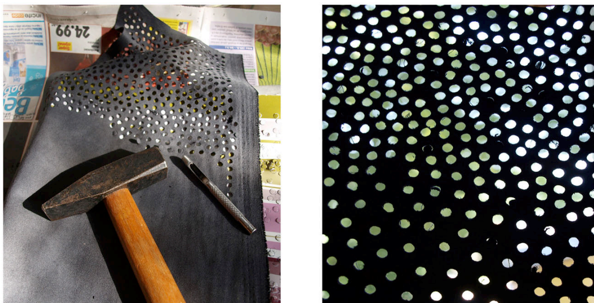
Sl.15 Realizacija perforacija u umjetnoj koži
