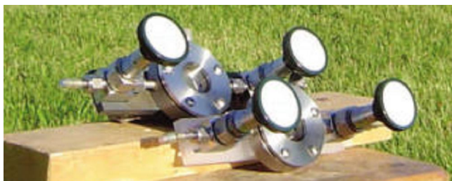
Slika 5: Reakcijske komore za fotokatalitičku konverziju \text{CO}_2
