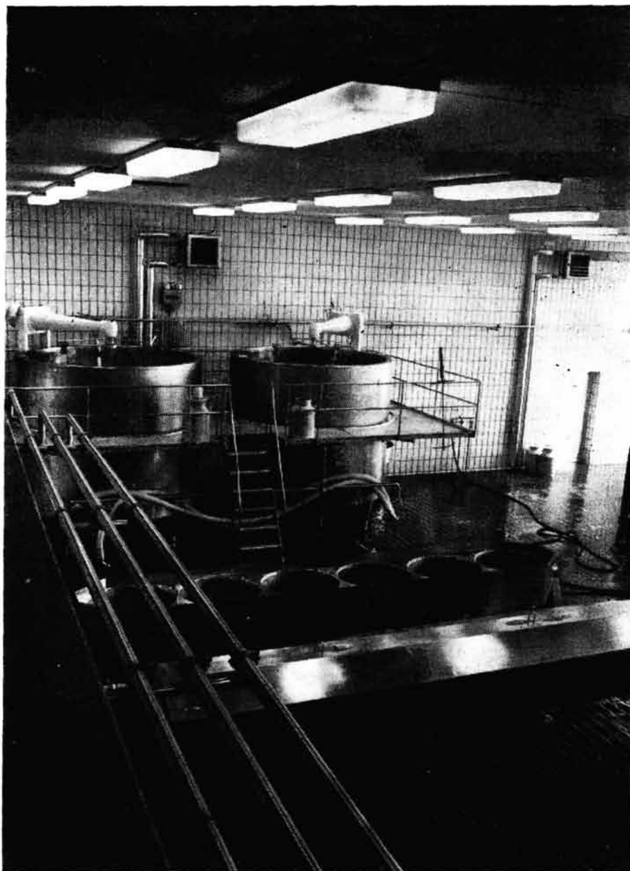
Linija za ementalac s programiranim kolonskim prešama u novoj sirani u Ljutomeru
