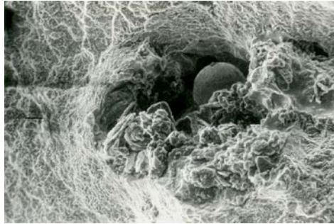
Figure 17 Part of the surface plane with the body of the circular shape Slika 17 Dio površine loma sa tijelom kružnog oblika
