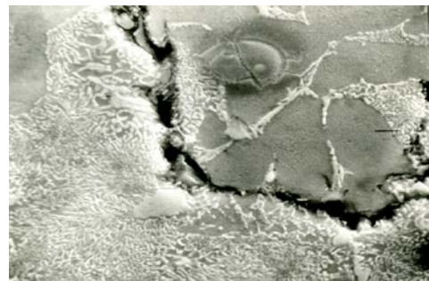
Figure 16 A Detail of Cold lap Slika 16 Detalj unutarnjeg udubljenja
