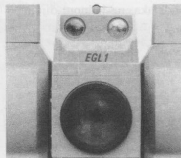
Slika 11. Upravljajuća svjetlost EGL1 na durbinu mjerne stanice.
