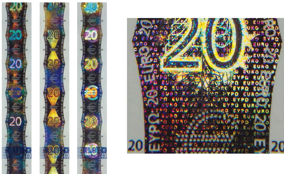
Slika 12: Kinematički efekti (lijevo) te detalj mikrotiska i laserske perforacije (desno) holograma novčanice od 20 € 39
