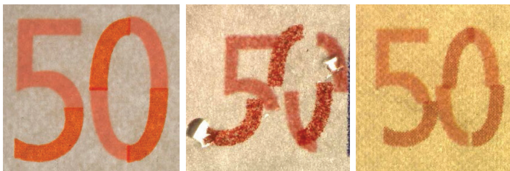
Slika 22: Prozirni registar – originalna novčanica (lijevo) i krivotvorene novčanice (desno) 51
