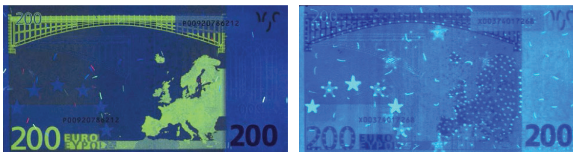
Slika 17: Zaštićeni paper (lijevo) i komercijalni paper (desno) u području UV zračenja 46
