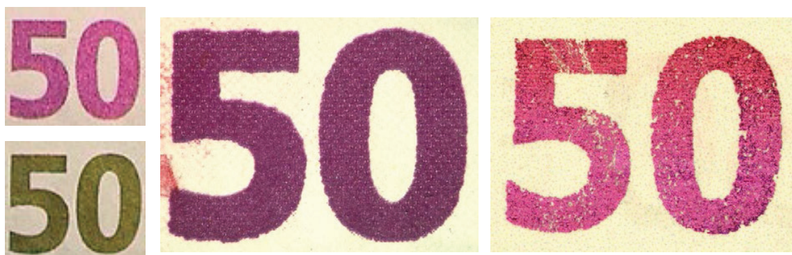
Slika 23: Promjena boje kod originalne optički promjenjive tinte (lijevo) i reprodukcije kod kojih ne dolazi do promjene boja (sredina i desno) 52
