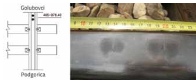
Slika 8. Višestruko squat oštećenje (tipičan oblik "pluća")
