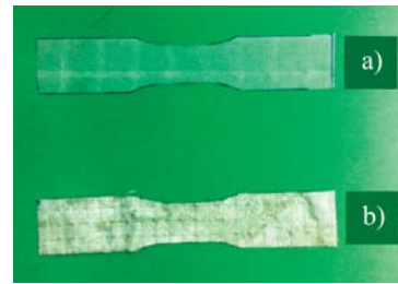
SLIKA 7 – Epruvete tkanina namijenjene za određivanje udarne rastezne žilavosti izrezane prije (a) i nakon (b) izlaganja atmosferskim uvjetima
