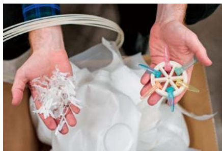
SLIKA 7 – Sirovina od plastičnih spremnika za mlijeko
