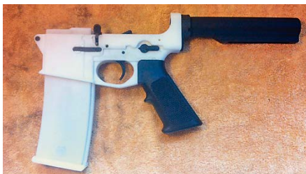
SLIKA 6 – Spremnik za metke i donji dio puške AR-15
