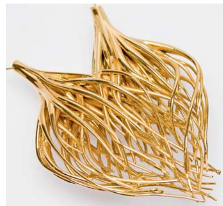
SLIKA 14 – Aditivna proizvodnja zlatnih tvorevina – nakit načinjen od 18-karatnog zlata (Foto: EOS )
