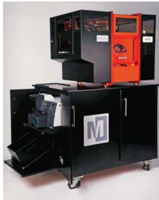
SLIKA 11 – Uređaj Iris za proizvodnju laminiranih papirnatih objekata (Foto: Mcor )
