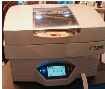
SLIKA 3 – Uređaj 3Z Pro za izradu tvorevina od voska (Foto: Ana PILIPOVIĆ)
