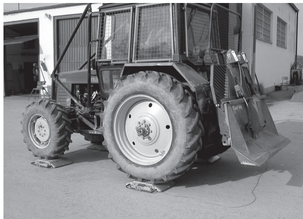
Slika 5. Adaptirani poljoprivredni traktor Belarus 1021 s dvobubanjским vitlom
