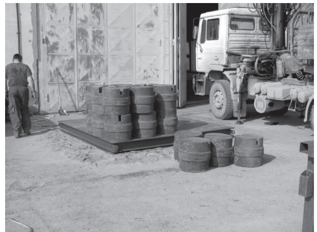
Slika 7. Umjeravanje mjerne platforme
