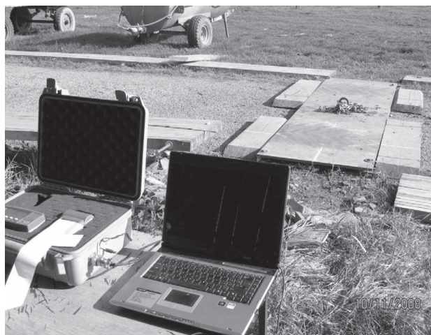
Slika 2. Sustav prijenosnih vaga WLS 101/R2K
