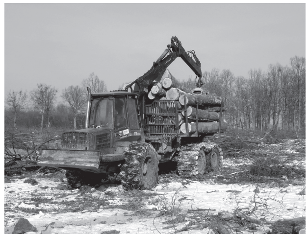
Slika 2. Rad forvardera u oplodnoj sječi hrasta lužnjaka
