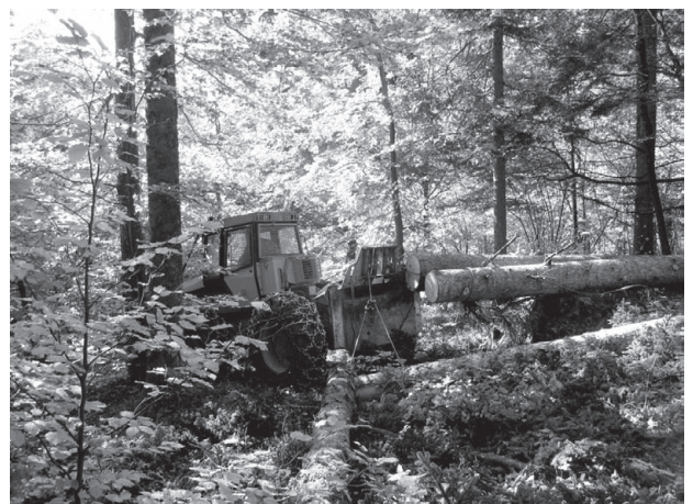
Slika 5. Rad domaćega skidera Ecotrac 120 na privlačenju drva iz preborne sječe na nagnutom terenu
