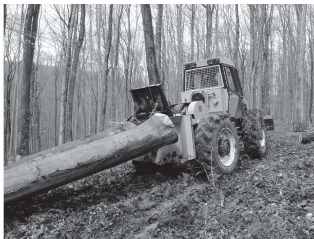
Slika 6. Rad maloga domaćega skidera Ecotrac 55 na privlačenju drva iz proreda na nagnutom terenu
