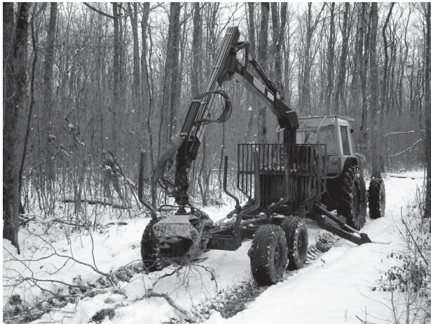
Slika 4. Rad ekipaže »Formet« na izvoženju drva iz proredne sječe po izvoznoj prosjeci, tzv. »šljukarici«
