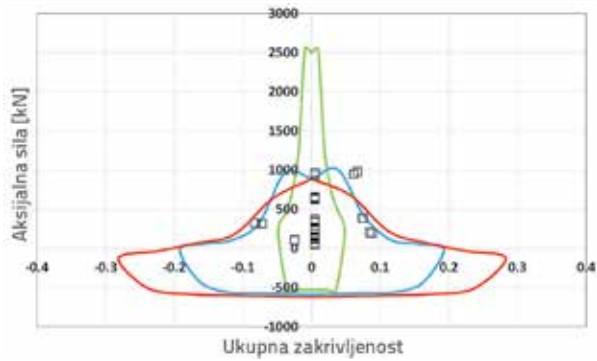
Slika 23. Procjena razine ponašanja za slučaj A analizom stupova dimenzija 300/600 mm u smjeru X
