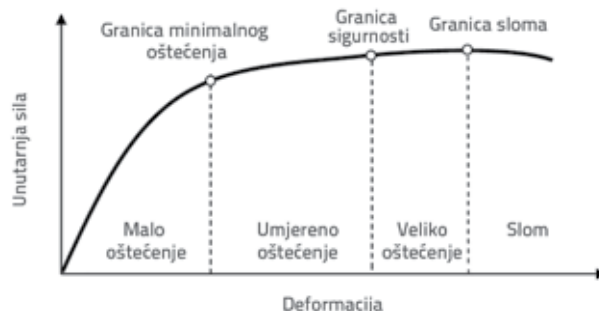
Slika 22. Stupnjevi ponašanja zgrada prema TSC-2007 [11]
