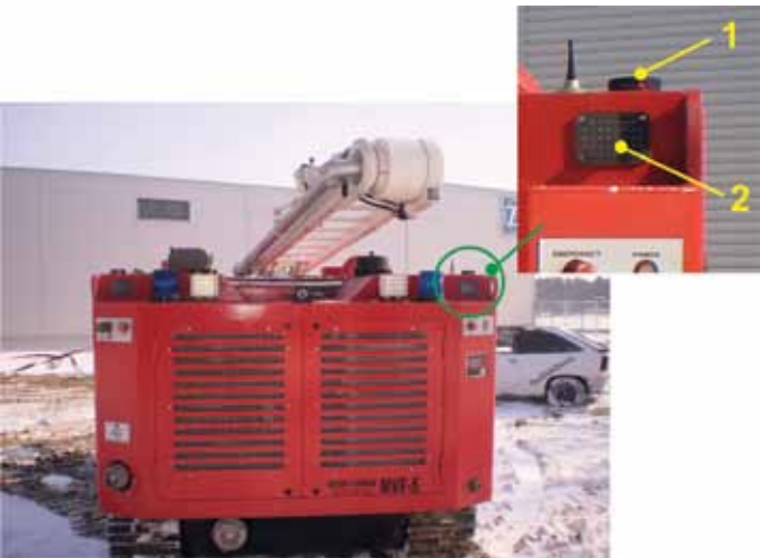
Slika 5. LED osvjetljenje (1-bljeskajuće sigurnosno svjetlo, 2-stroboskopsko upozoravajuće svjetlo)
