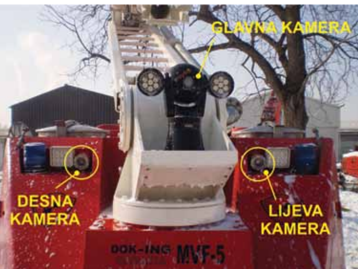
Slika 7. Kamere smještene na prednjoj strani vozila
