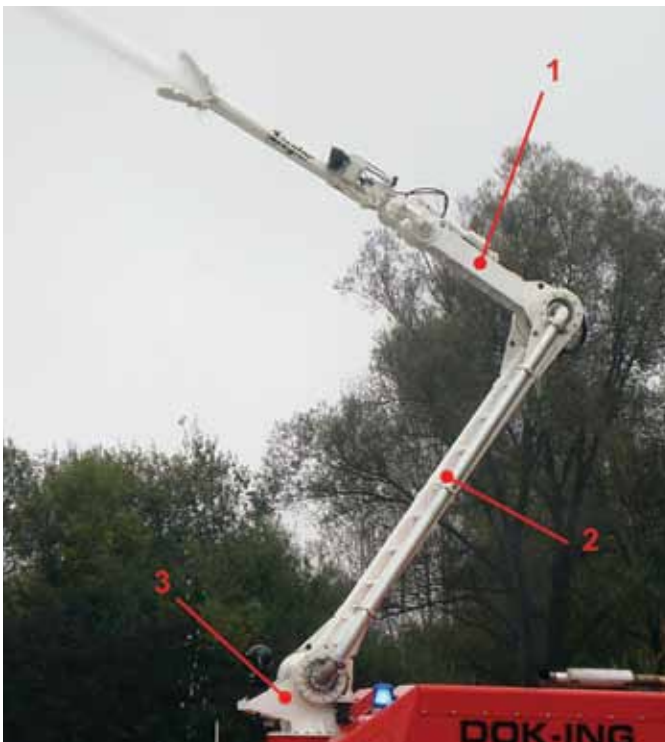
Slika 18. Hidraulički kraci (1-završni nastavak, 2-ruka kraka, 3-rotirajuća kupola)
