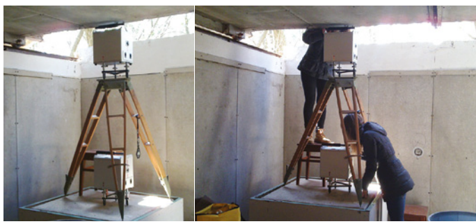
Slika 4.3. Postavljanje i horizontaliranje instrumenata
