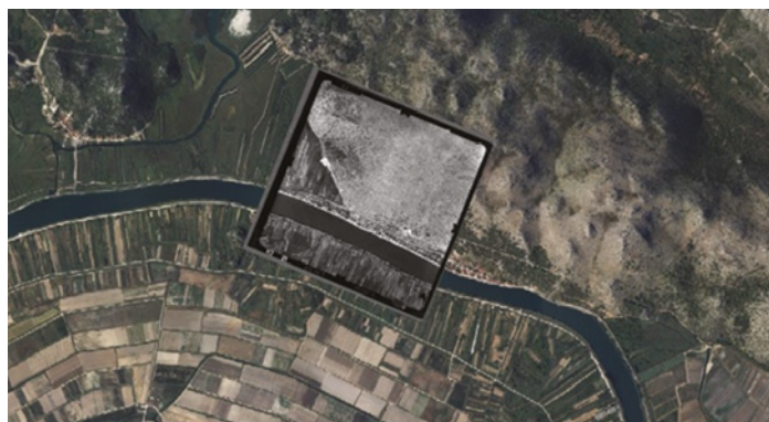
Slika 4.7. Primjer snimke preklapljen sa DOF-om iz 2011. god sa naznačenim veznim točkama detalja, (Metković_CN61,niz 7, snimka 68, godina nastanka 1961., k.o. Komin)
