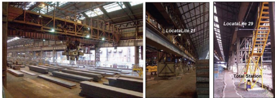
Slika 4.2. Pseudoliti u pozicioniranju tvorničke opreme i materijala (Barnes i dr., 2004)
