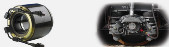
Slika 3.2. Senzor postavljen na nosive brtve (lijevo), Senzor postavljen na prednju stranu osovine (desno) (URL-4)
