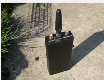
Slika 4.1. GPS ometač Portable Mobile Signal Jammer • jedna frekvencija (L1) • Omni – directional antenna (CDMA/GSM, 3G, DCS/DHS) • vrijeme rada: 3 – 4 sata • masa: 180 g • radijus ometanja: do 15 m
