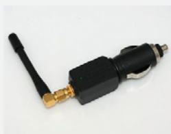
Slika 2.3. GP5000 GPS Jammer (URL-4) GP5000 Car Anti-Tracking GPS Blocker, Navigation Jammer (URL-3) • raspon frekvencija rada: L1 • radijus djelovanja: 5 metara • jedna eksterna antena • napajanje: auto upaljač 12V/ 24V
