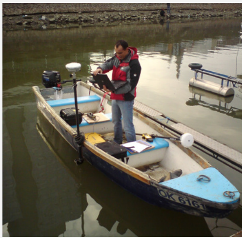
Slika 3.2. Integrirani sustav satelitskog pozicioniranja i ultrazvučnog mjerenja dubina
