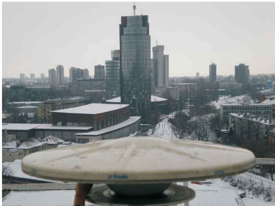
Slika 1. GNSS-antena na tornju RGN fakulteta.
