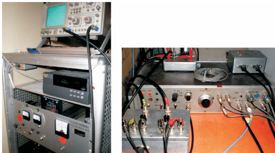
Slika 9. Upravljačka konzola, napajanje, data-logger, senzor tlaka zraka i elektronika.
