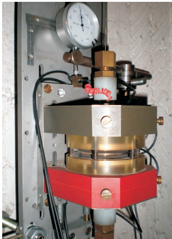
Slika 3. Nosač senzora i vijci za podešavanje.
