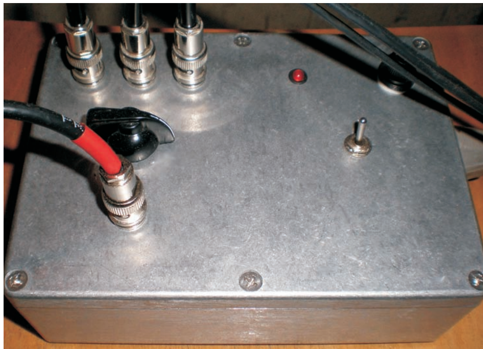
Slika 4. Kućište elektronike vertikalnog ekstenzometra.
