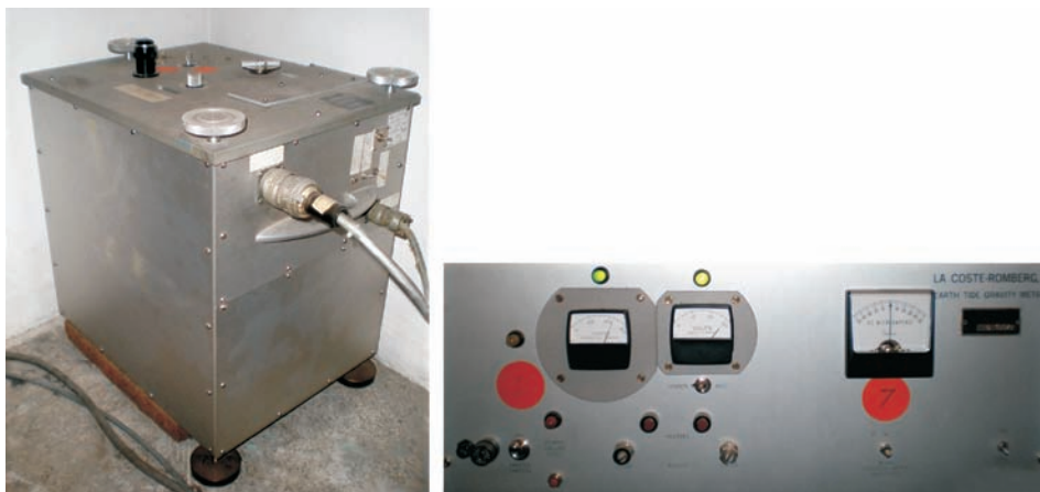
Slika 8. Gravimetar LaCoste & Romberg ET 16 u zaštitnom kućištu i upravljačka konzola.
