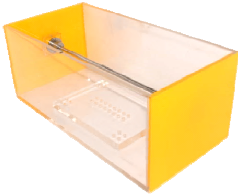
Figure 7 Box barge model Slika 7 Model prizmatičnog pontona
