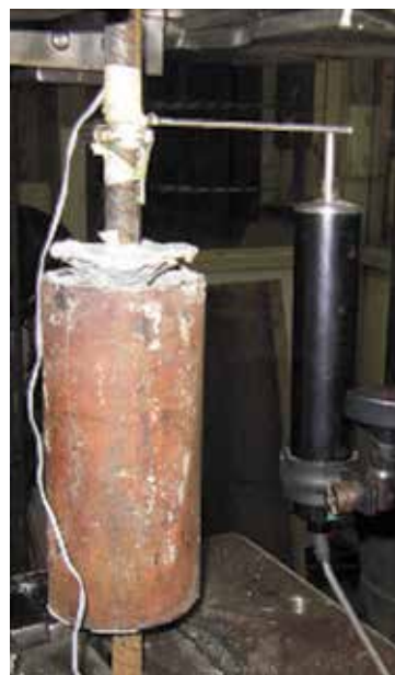
Slika 10. Način sloma uzorka S3
