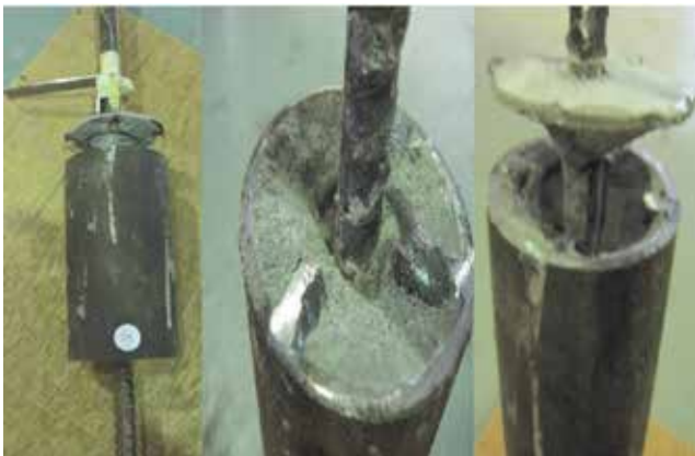
Slika 11. Proklizavanje spojne šipke slijeva nadesno: P15 D35, P25 D35 i P35 D35
