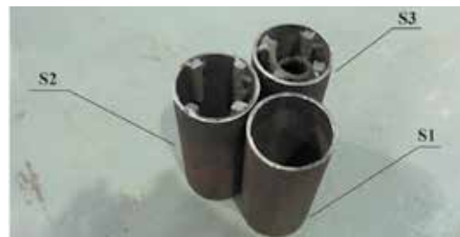
Slika 2. Konfiguracija kontrolnih uzoraka S1, S2 i S3
