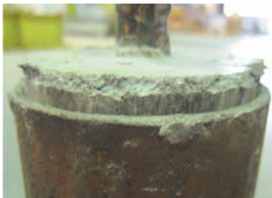
Slika 8. Način sloma uzorka S1
