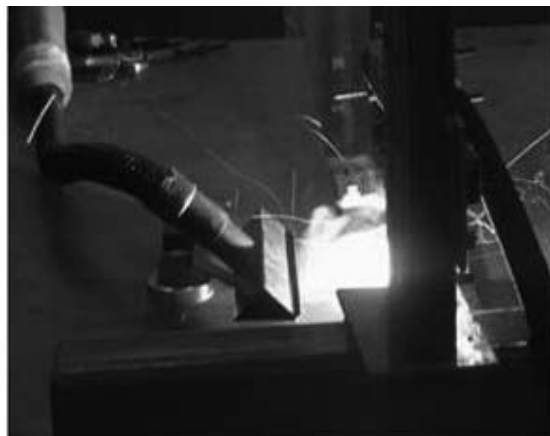
Slika 2. Izvedba ventilacije na mjestu izvora (lokalna ventilacija) Figure 2. Exhaust ventilation at source (local ventilation)
