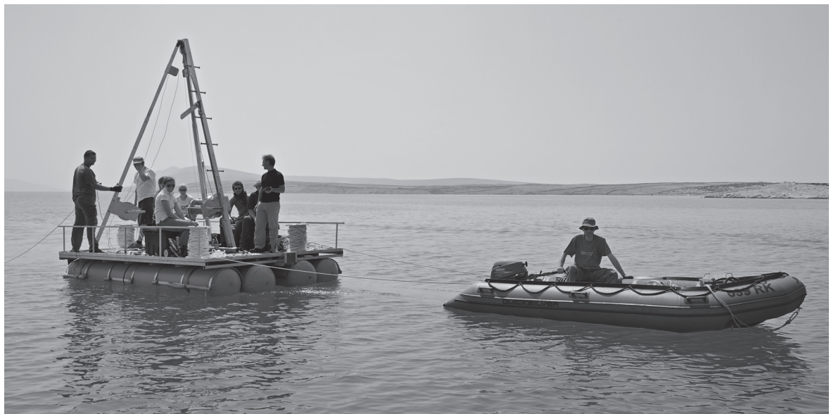
Slika 12. Hrvatski geološki institut; splav za geološko sondiranje (foto: L. Damelet)
