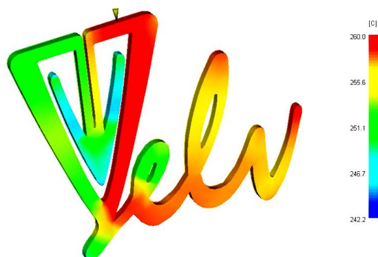
Slika 6. Temperatura čela taljevine za položaj ušća I
