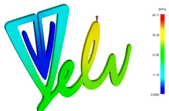
Slika 9. Tlak u kalupnoj šupljini za položaj ušća II
