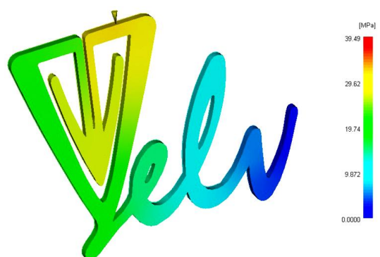
Slika 8. Tlak u kalupnoj šupljini za položaj ušća I
