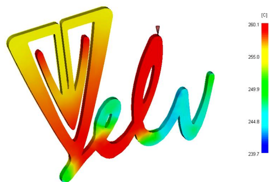
Slika 7. Temperatura čela taljevine za položaj ušća II
