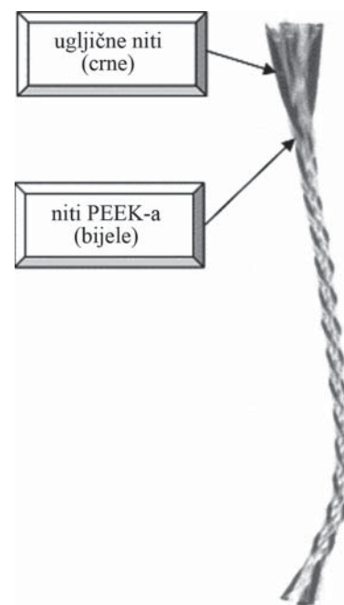
SLIKA 3 – Tkanina ispletena od ugljikovih niti (crnih) i niti PEEK-a (bijelih) 9
