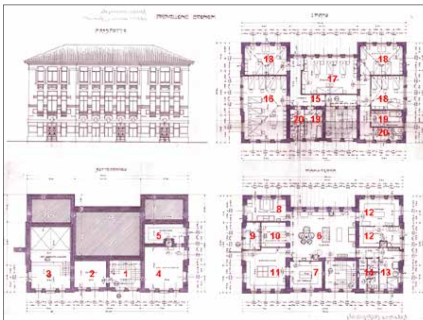
Slika 6. Paviljon gospodarstva, glavno pročelje i tlocrti suterena, prizemlja i kata: Suteren: 1. ulaz i stubište, 2. spremište, 3. kotlovnica sa spremištem ugljena, 4. spremište namirnica, 5. ledara; Prizemlje: 6. kuhinja, 7. prostor za posuđe (office), 8. praonica agruma, 9. dostava namirnica, 10. distribucija namirnica, 11. praonica suđa, 12. ostava, 13. klaonica 14. sanitarne prostorije; 1. kat: 15. hodnik, 16. 8-krevetna spavaonica, 17. 6-krevetna spavaonica, 18. 4-krevetna spavaonica, 19. kupaonica, 20. zahod
