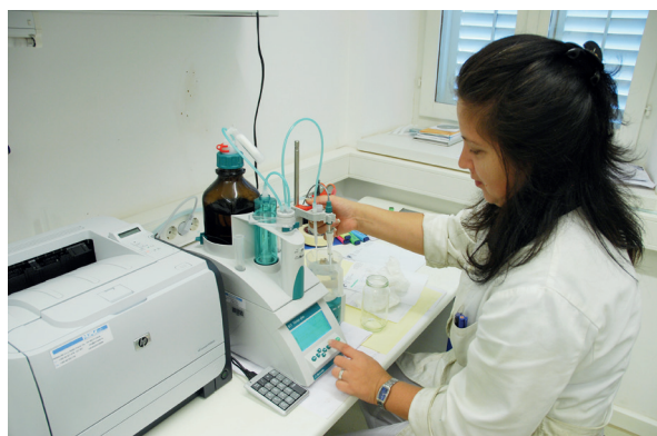
5. Mjerenje količine klorida potenciometrijskim titratorom (fototeka HRZ-a, snimio M. Mustaček)
