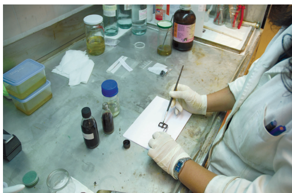
10. Nanošenje konsolidanta na predmet premazivanjem (fototeka HRZ-a, snimio M. Mustaček)
