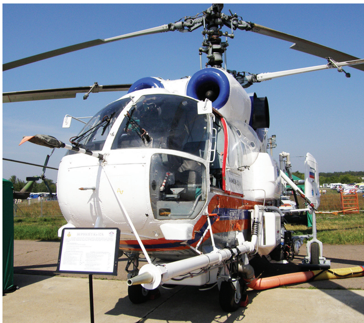
Slika 3. Vodeni top za gašenje požara instaliran na helikopteru Ka-32A
