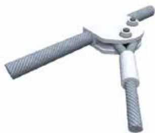
Slika 8. Spoj unutarnjega kabela na rubni (prema [19])
