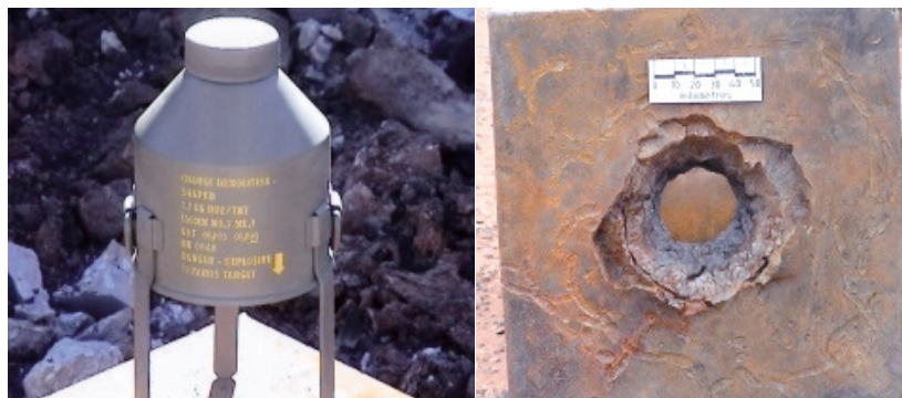
Slika 1. Konusni kumulativni naboj i perforacija nakon detonacije ( www.appliedexplosives.com/images/stories/smallbook.pdf )
