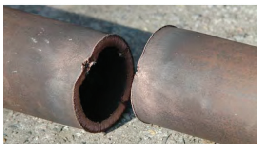
Slika 6. Čelična cijev prerezana primjenom linijskog kumulativnog rezača Figure 6. Steel pipe cut using linear shaped charge
