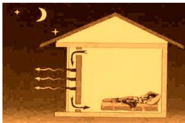
Slika 11. Hlađenje Trombovog zida zračenjem [12]
