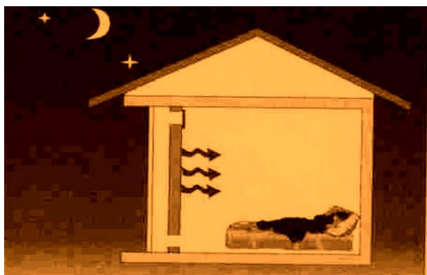
Slika 10. Zračenje Trombovog zida tijekom noći [12]
