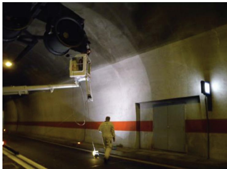
Figure 6. Sampling from concrete lining of the Sv. Tri Kralja Tunnel (Mavar, 2011) Slika 6. Uzimanje uzoraka iz betonske obloge tunela Sv. Tri Kralja (Mavar, 2011)
