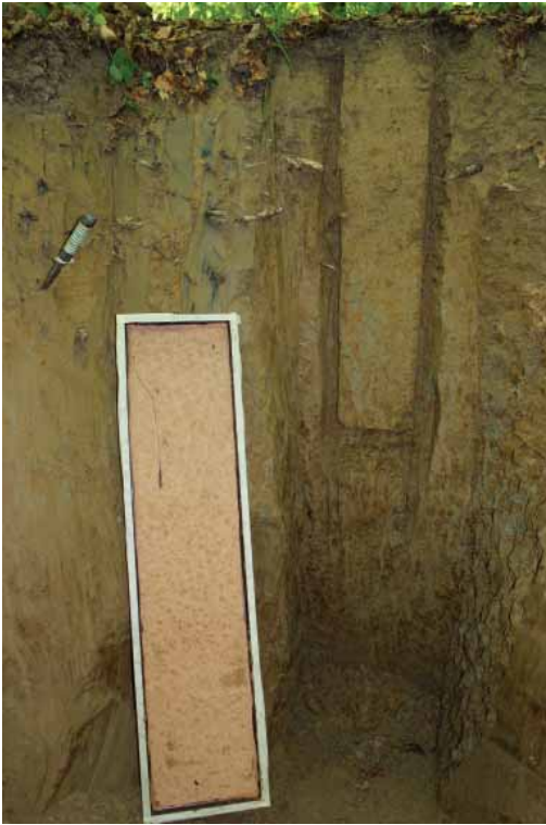
Slika 7. Priprema profila za uzimanje monolita Figure 7 Profile preparation for monolith takes
