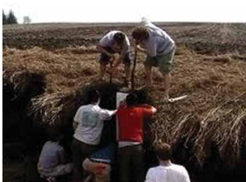
Slike 13, 14 i 15. Obrada profila tla za uzimanje monolita u drvene sanduke
