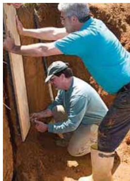
Slike 13, 14 i 15. Obrada profila tla za uzimanje monolita u drvene sanduke
