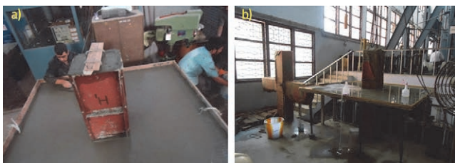
Slika 4. Izrada uzoraka za ispitivanje: a) ugradnja betona - uzorak JS; b) njega pokusnih uzoraka
