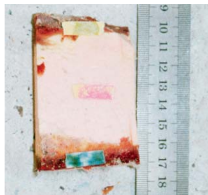
SLIKA 1 – Ispitivanje pH vrijednosti fenolne izolacije
